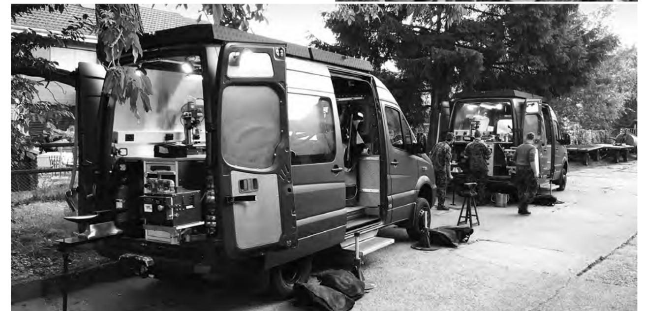
Les nouveaux véhicules équipés d'une forge et de l'ouillage complet de maréchalerie
