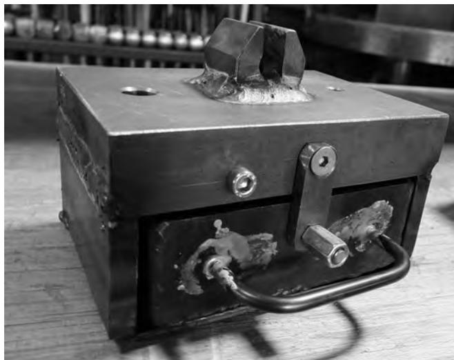
Die Prüfungsarbeit der Konstruktion: eine «Stollenkiste» zum Ausdornen und Entfernen von Stollen und Hartmetallstiften.
