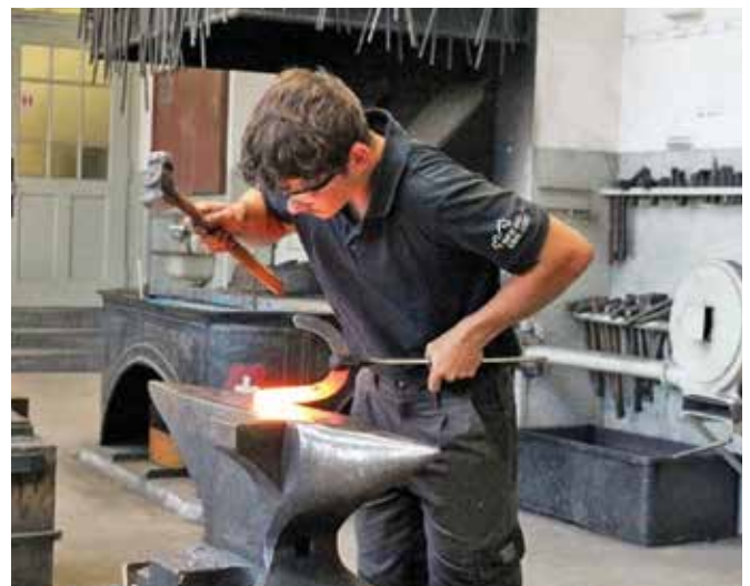
Livio beim Schmieden eines neuen Hufeisens in der Schmitte des Nationalen Pferdezentriums in Bern (Fotos: Lydia Henkel)
