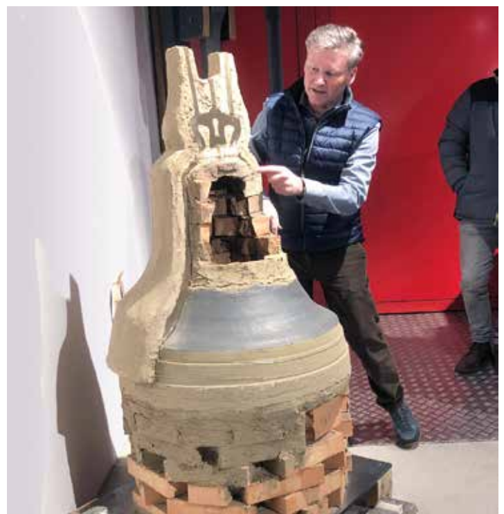
Anhand eines Querschnitts wurde der Guss einer Glocke erklärt
