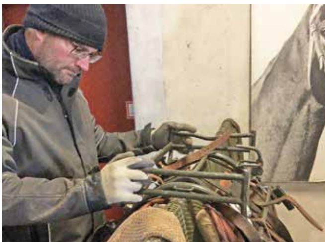
Kontrolle der Lastgestelle: ist etwas verbogen und sind die Riemen noch intakt?
